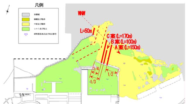
図-17 航路埋没対策工法
