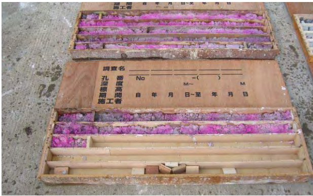
写真-8 チェックボーリング試料の状況
