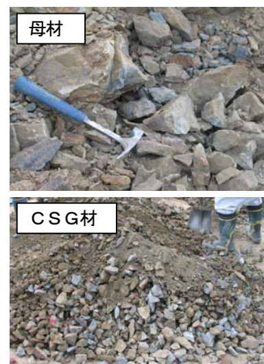
写真-1 母材およびCSG材の状況
