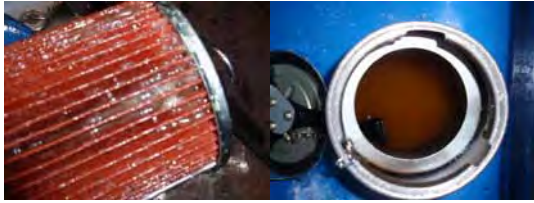
写真-2 始動不能時の燃料フィルター及び燃料(FAME2)の状態
