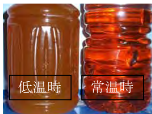
写真-3 温度による燃料(FAME2)の状態変化
