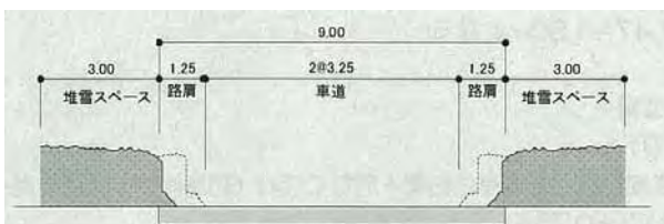
図-2 モデルとした道路定規図 12)
