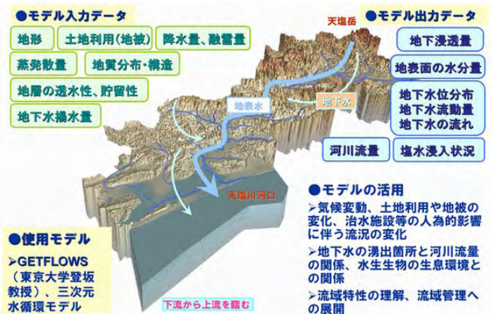
図-2 GETFLOWSによる水循環モデルの概要
