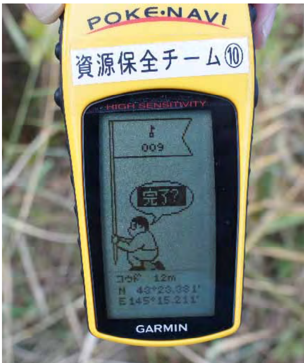
写真-1 GPS機器による緯度・経度の計測状況
