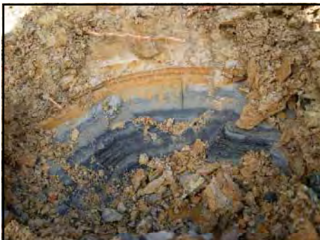
写真-4 地点番号33の法面を20cmほど掘削して露出した酸性硫酸塩土壌
