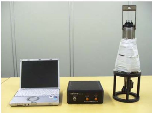
写真-1 Compact-CTD計(右)とインターフェイス(中)
