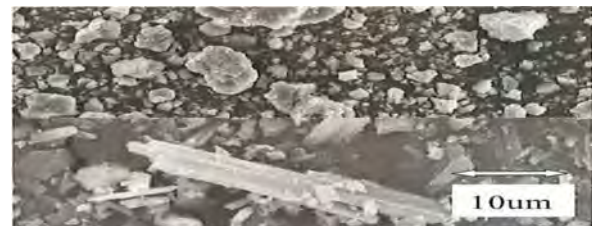
写真-2 ホタテ貝殻粉末と石粉の形状の違い (上：石粉 下：ホタテ貝殻粉末)
