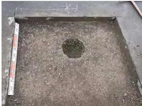
写真-11 セメントコンクリート再生骨材(下層路盤)
