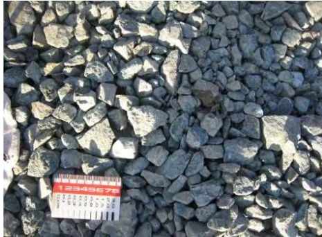
写真-7 2 工区 通常骨材(40m/m 級)
