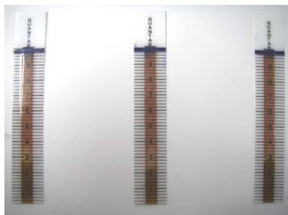
図-1 塩化物濃度測定計の外観
