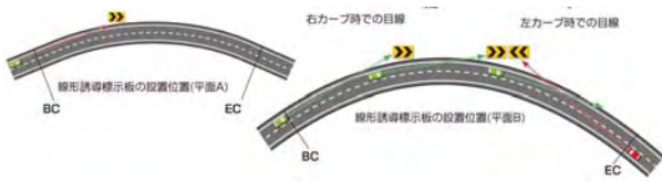
図-11 本整備手法で提案する線形誘導標示板の設置位置
