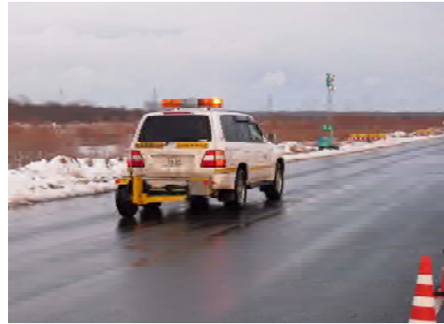
写真-2 すべり抵抗値（HFN）の測定状況
