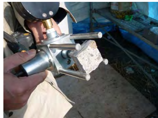
写真-13 付着強度試験後の状況一例
