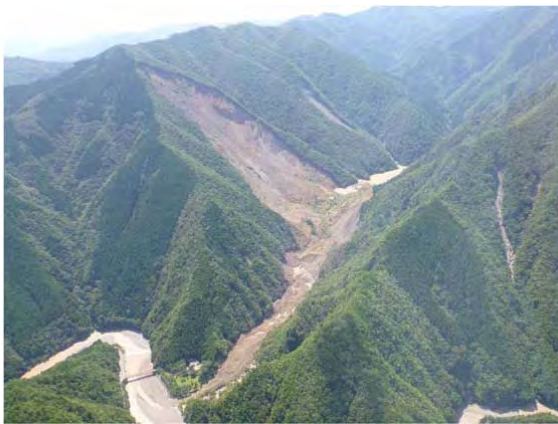
写真-1 平成23年台風12号による河道閉塞 奈良県熊野川（十津川）流域五條市大塔町赤谷
