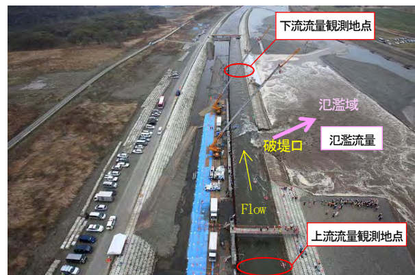
図-1 千代田実験水路における越水破堤実験の様子
