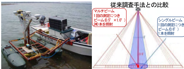
図-19 マルチビーム測深機の概要
