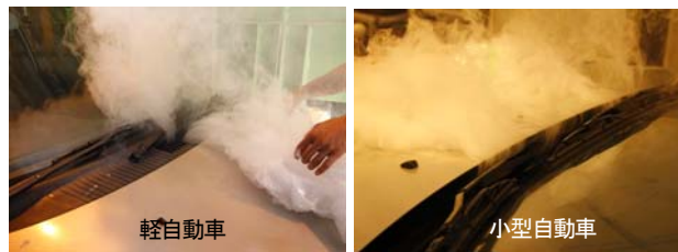
写真-5 外気導入時におけるフロントワイパー下部開口からの外気取込状況 (スモーク試験)
