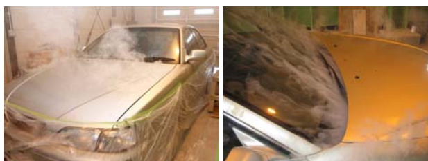
写真-6 ボンネット隙間からの流出状況 (小型自動車、エンジン停止、車両下でスモーク発生)
