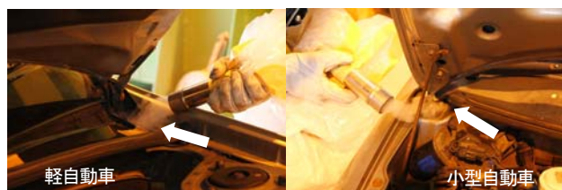
写真-7 フロントワイパー下部開口閉塞時における外気取込状況 (スモーク試験)
