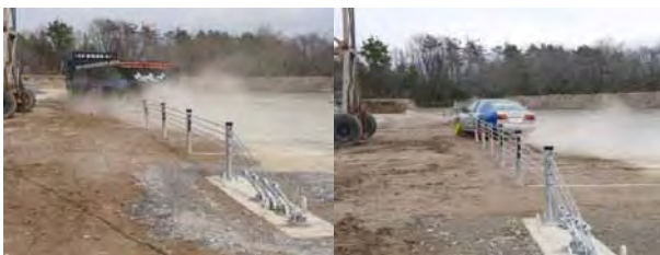
写真-11 衝突時の状況 (左: 大型貨物車, 右: 乗用車)
