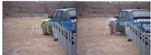
写真-4 ワイヤーロープ式防護柵の衝突実験状況 8)
