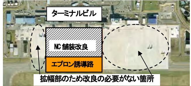
写真-5 エプロン改良箇所
