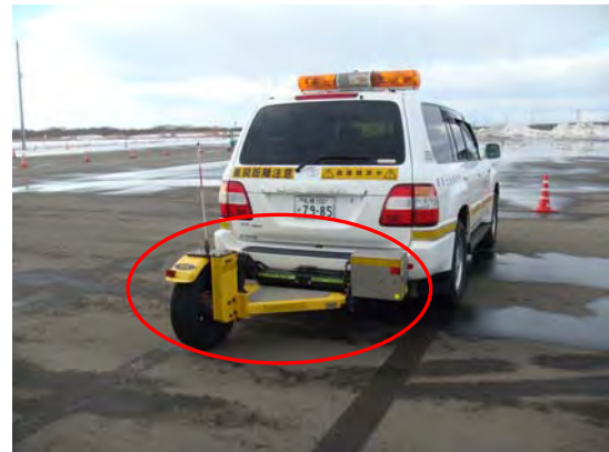
写真-2 連続路面すべり抵抗値測定装置 (CFT)
