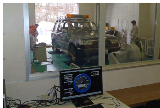
写真-2 シャンダイナモメータでの試験状況
