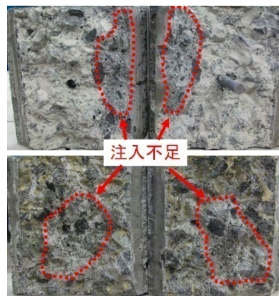
注入不足の供試体例
