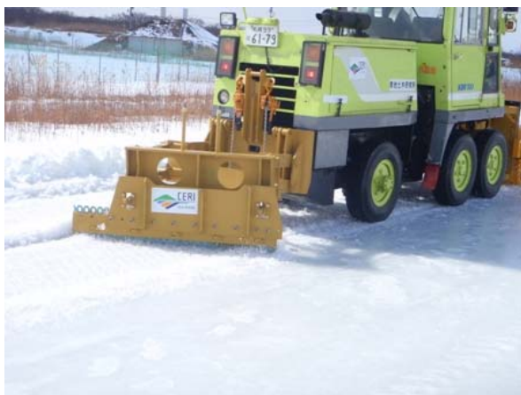
写真-7 後方排雪装置施工状況（氷板路面）
