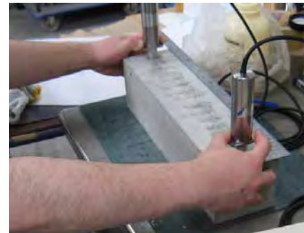
写真-1 表面走査法による測定状況
