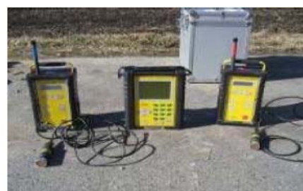
写真-2 関連式漏水探査機
