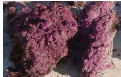
写真-2 試薬反応による混合性確認(32%添加量)
