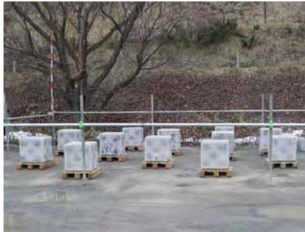
写真-2 曝露試験の状況
