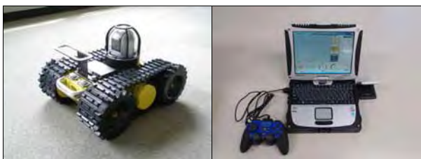
写真-2 改造前の自走装置（左側）と操作用パソコン（右側）
