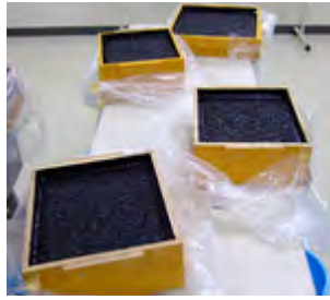
写真-4 組み込み供試体 実験 (横断2%縦断0.5%)
