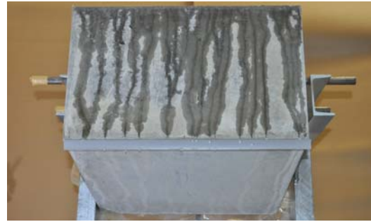
写真-6 水切り材設置 (ケース4)
