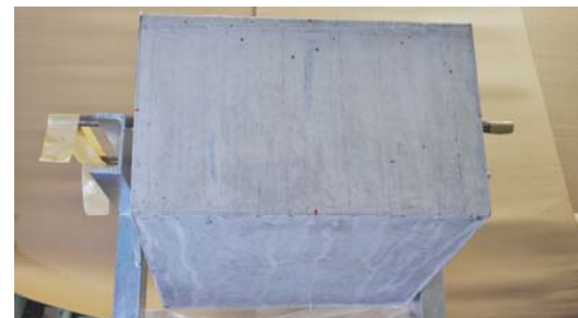
写真-7 上面側面に含浸材塗布 (ケース10)
