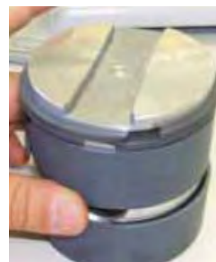
写真-8 ピストンリング取付状況
