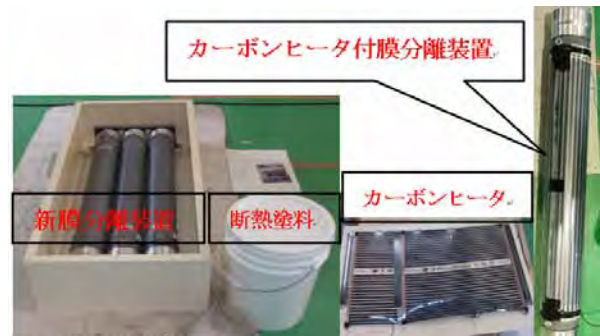
写真-6 膜分離装置改造部品
