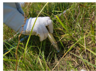
写真-5 土壌硬度測定状況(山中式)
