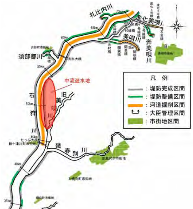
図-1 石狩川中流域の河道掘削計画
