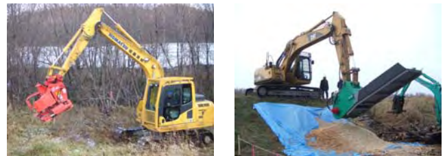
図5 試験施工に使用した伐採機械(左)と破砕機械()
