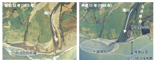
図-1 河口干潟の侵食状況（昭和53年→平成11年）
