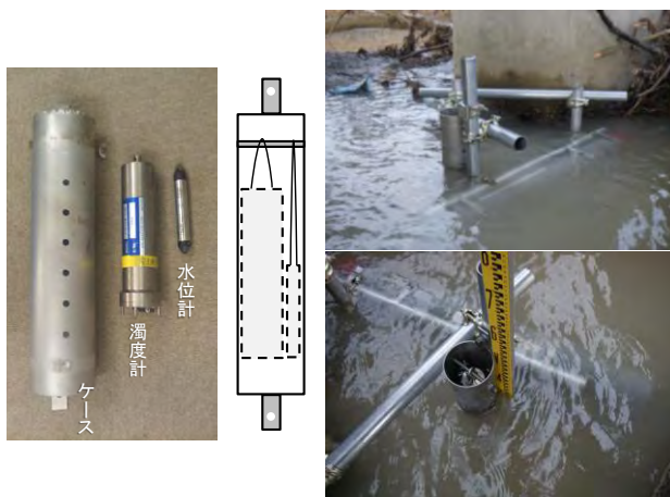
図-2 水位計・濁度計の設置例
