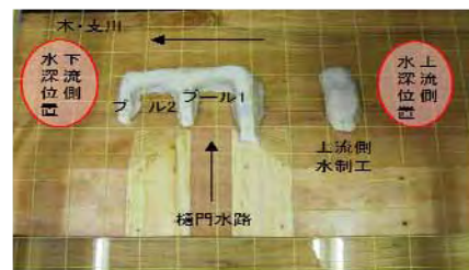
写真-2 箱型隔壁モデル
