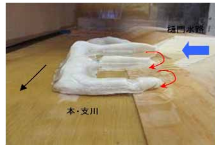
写真-5 プールからの越流状況
