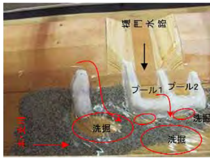
写真-6 流況・土砂流出状況
