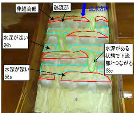
写真-7 隔壁を越流しない流量での流況 (1案)
