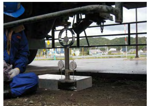
写真-1 現場CBR試験
