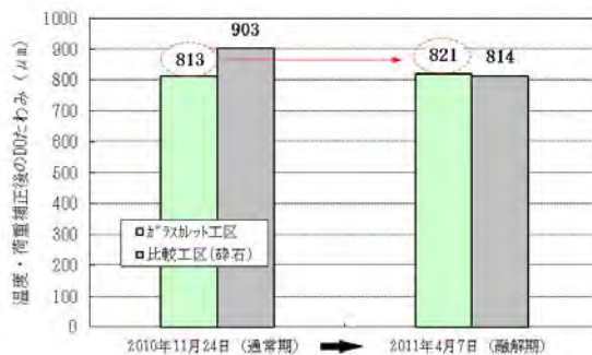
図-13 FWD 試験による D0 たわみ量比較
