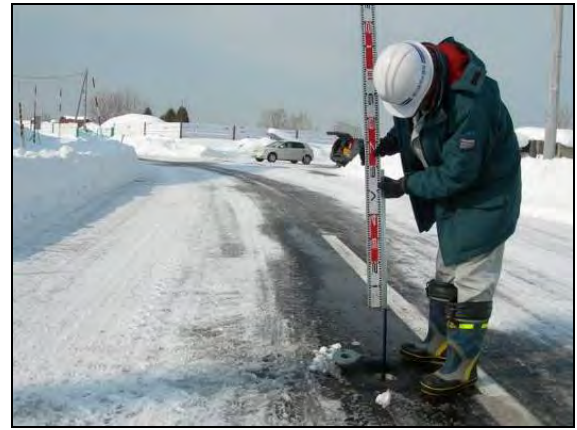
写真-4 メチレンブルーによる凍結深さ測定状況
