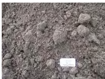
写真-12 固化破碎土状況(H23施工)
