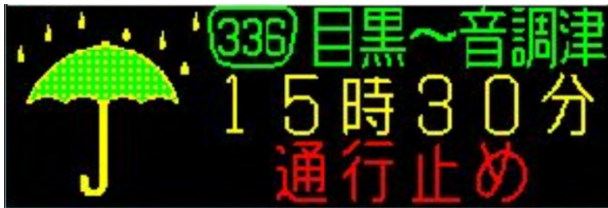
図-13 通行規制開始予定の道路情報板表示
