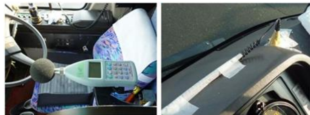
写真4 大型バス車内における騒音、振動測定の様子
