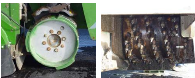
写真-2 突起型車輪の形状および切削ドラム
