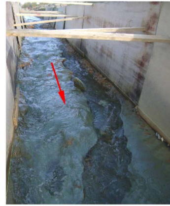
図-4 石狩川上流の現地実験水路(実験終了後の水路床) 5)
