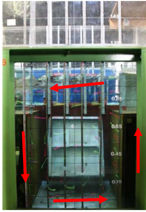
写真-2 タフトを用いた排水溝内の流況
