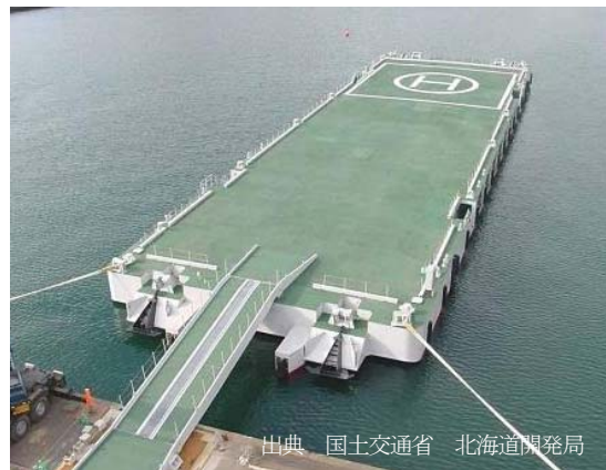
写真-2 防災フロートの係留(イメージ)
