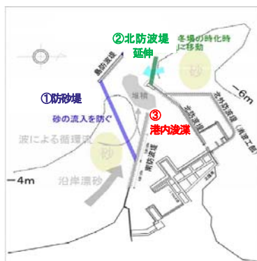
図-6 防砂堤新設・北防波堤延伸計画
