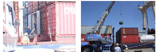
(a) 冷凍水産品のデバンニング (b) モッコによる荷役状況 写真-6 トライアル事業における冷凍水産品の荷役状況
