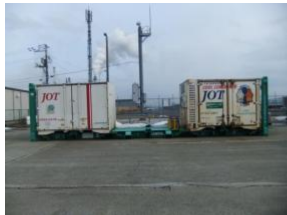
図-13 フラットトラックコンテナへの12ft コンテナ設置状況
