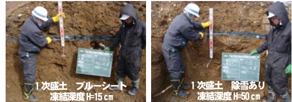
写真-5 試験盛土開削凍結深度確認 (H24/3/6時点) (左:ブルーシート, 右:裸地)
