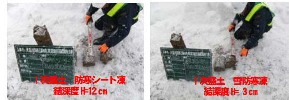
写真-6 試験盛土コア凍結深度確認 (H24/2/3時点) (左:防寒シート, 右:雪防寒)
